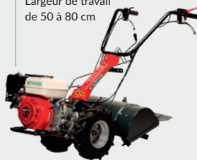
Série de tracteurs à deux roues avec moteur Honda Largeur de travail de 50 à 80 cm
