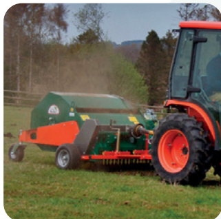
MTX-120-P nettoyeur de paddock tracté Pour prise de force de tracteur Largeur de travail 120 cm
