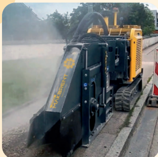
MAK 630 trancheuse automotrice Moteur diesel Kubota Disque de fraisage 10 × 63 cm
