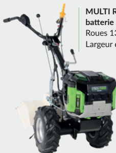
RT50R – fraise rotative à batterie avec 4 couteaux et 2 disques Largeur de travail 50 cm
