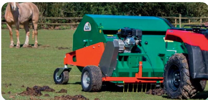
MTX-120-P nettoyeur de paddock tracté Pour prise de force de tracteur Largeur de travail 120 cm
