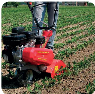
RT 401 motobineuse monoroue Moteur Honda Largeur de fraisage de 32 à 50 cm
