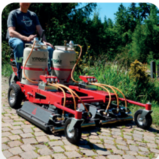
MASTER PRO – brûleur infrarouge Autotrtracté avec siège Surface de brûlage 1.020 × 600 mm
