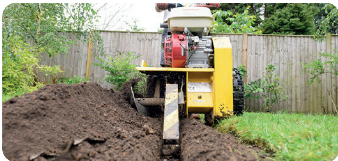
Trancheuse TR-12 avec moteur Honda Profondeur de tranchée : 15 à 40 cm Largeur de tranchée : 10 cm Vitesse 60 m/h
