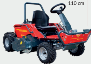
Série FOX 4WD de tracteurs à broyeur à fléaux avec transmission à 4 roues motrices Moteur à essence B&S 110 cm
