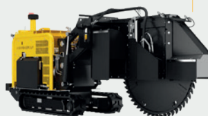
MAK 630 trancheuse automotrice Moteur diesel Kubota Disque de fraisage 10 × 63 cm
