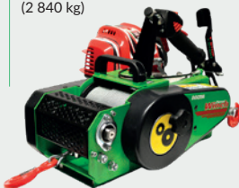
VF150 AUTO-4 – treuil forestier à câble Moteur essence Honda, 50 cm 3 Câble en acier : 80 m × Ø 5 mm Force de traction maximale : 1 420 kg (2 840 kg)
