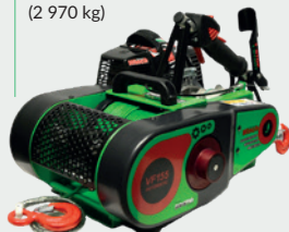
VF155 AUTO – treuil forestier à câble Moteur essence Solo, 50,8 cm 3 Câble en acier : 80 m × Ø 5 mm Force de traction maximale : 1 485 kg (2 970 kg)
