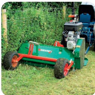
Série de broyeurs à fléaux tractés Moteur Briggs & Stratton OHV Largeur de travail 120 et 160 cm
