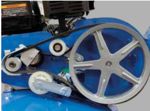
COURROIE KEVLAR® ET POULIE ALUMINIUM
