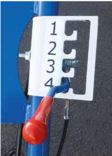
LEVIER DE CHANGEMENT DE VITESSE 4 avant + 1 arrière
