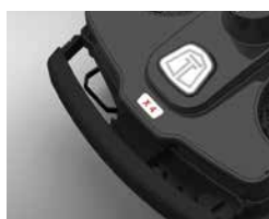
Capteur de pare-chocs et d'obstacles souples
