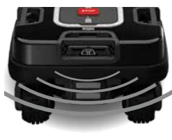
RADAR pour la détection d'obstacles
