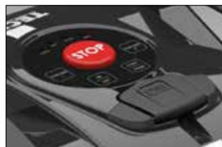
Commandes du clavier et point de charge
